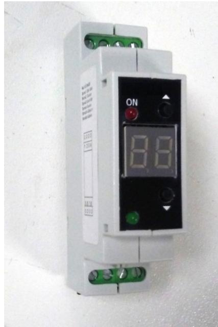
El módulo CRE1, permite fijar una consigna a través de sus displays y pulsadores y activar un relé en función del estado de la señal de entrada ( mayor o menor que consigna, ventana entre dos consignas ... ). El valor de la señal de entrada se visualiza en los displays. Se pueden activar también dos relés con funciones combinadas. Se monta en carril DIN.
