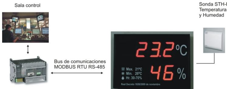
**DTH-C-TCP** dispose d'une sonde externe pour faciliter les lectures de température et d'humidité locales (sonde incluse avec un câble de 5 m) et peut transmettre des informations de température et d'humidité via un bus de communication Modbus TCP, ainsi que des paramètres d'affichage de température et d'humidité que vous souhaitez écrire.
