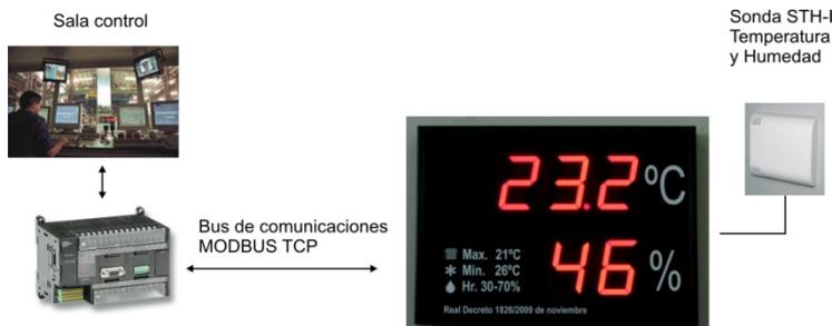
**DTH-EA** permet la connexion de deux entrées analogiques externes pour la température et l'humidité. Comprend un cordon d'alimentation.
