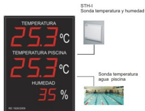
**DTTH -C** cuenta con una sonda externa para facilitar lecturas de la temperatura y humedad del interior del recinto de la piscina ( sonda interior incluida con cable 5m ) y otra para la medición de la temperatura del agua ( ver especificaciones ). Puede transmitir la información de temperatura a través de un bus de comunicaciones Modbus RTU RS485 o recibir datos a escribir en la pantalla. Incluye cable alimentación.
