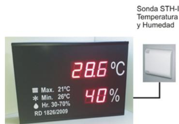
**MTH-C** cuenta con una sonda externa para facilitar lecturas de la temperatura y humedad local (sonda incluida con cable 5m) y puede transmitir la información de temperatura y humedad a través de un bus de comunicaciones Modbus RTU RS485, así como mostrar los parámetros de temperatura y humedad que se deseen escribir. Incluye cable alimentación.
