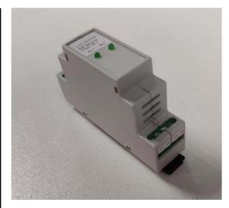
El modulo XRD2C es un driver de 2/4 entradas analogicas de 0-10V de baja corriente, que permite activar dos/cuatro salidas de reles con tensiones apartir de los 1.5 V. Cada salida de rele dispone de un contacto NO ( opción –S ,SPST ) o NO/NC ( opción –D SPDT ) y led indicador de estado. Viene montada en caja completa para carril DIN.
